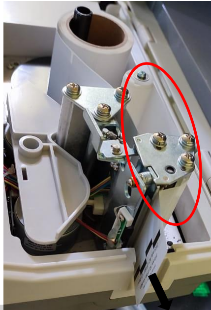
Fig. 12 – Sistema de re-embobinado del papel de respaldo.
