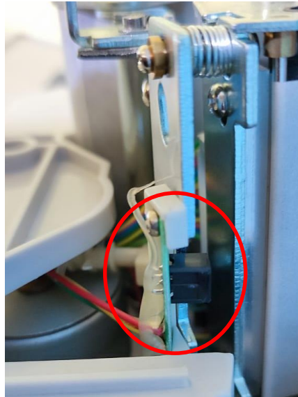
Fig. 15 - Sensor de salida de papel.
